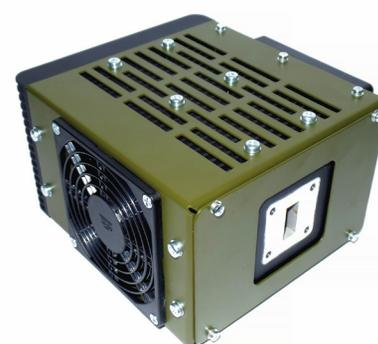
По индивидуальному заказу возможна поставка согласованных волноводных нагрузок с параметрами, отличающимися от параметров серийных НСВ1. Например, возможно изготовление мощной волноводной согласованной нагрузки в тракте 23 × 10 мм с максимальной средней мощностью непрерывного сигнала до 500 Вт (с активным воздушным охлаждением, см. рисунок 3).
