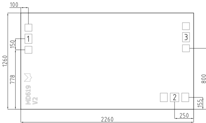
Рисунок 12 – Габаритные и присоединительные размеры кристалла
