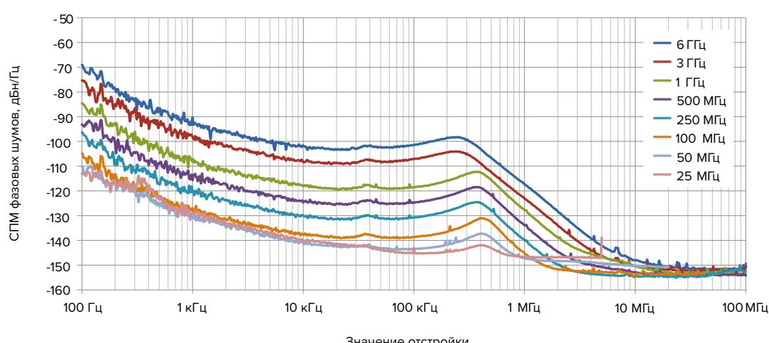
**Фазовый шум генератора PLG12**
