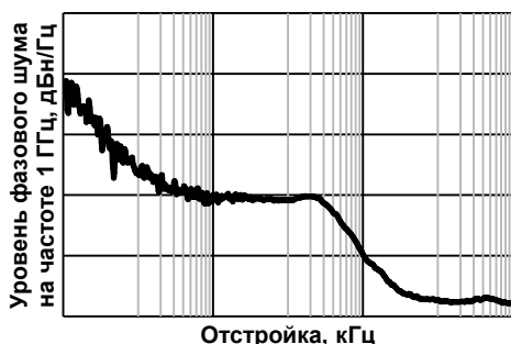
Рис. 2. Спектральная плотность мощности фазовых шумов выходного сигнала на частоте 1 ГГц.
