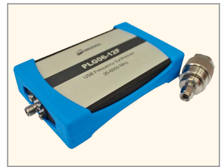
Рис. 10. Внешний вид СВЧ USB-генератора PLG06
