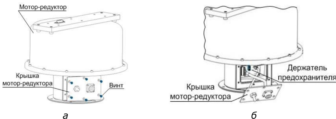
Рисунок 8 – Замена предохранителя в мотор-редукторе
