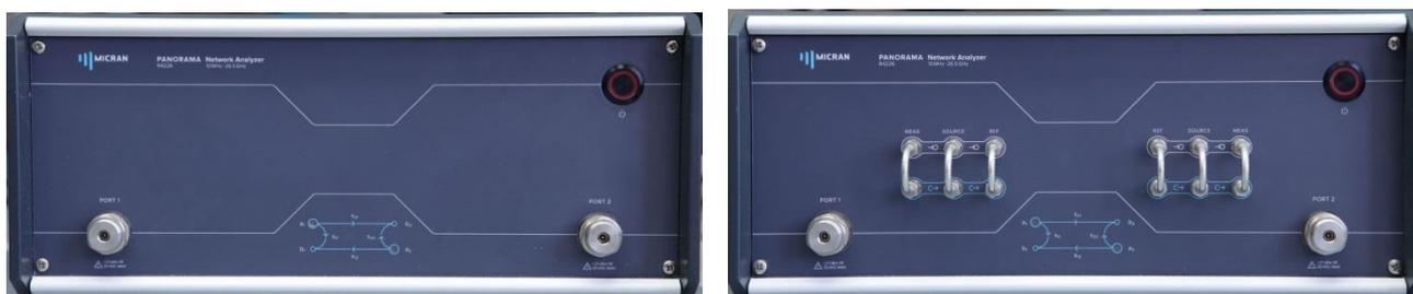
Рисунок 4.2 – Внешний вид векторного анализатора цепей P4226 (передняя панель).
