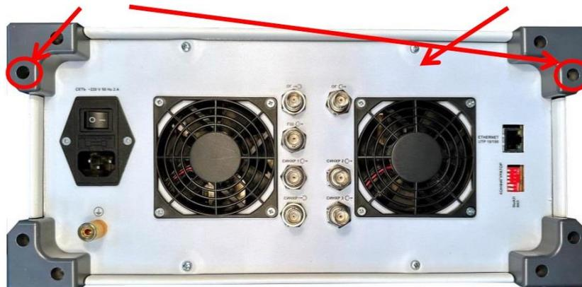
Рисунок 4.5 – Общий вид задней панели Р4226А (для одного из вариантов исполнения).
