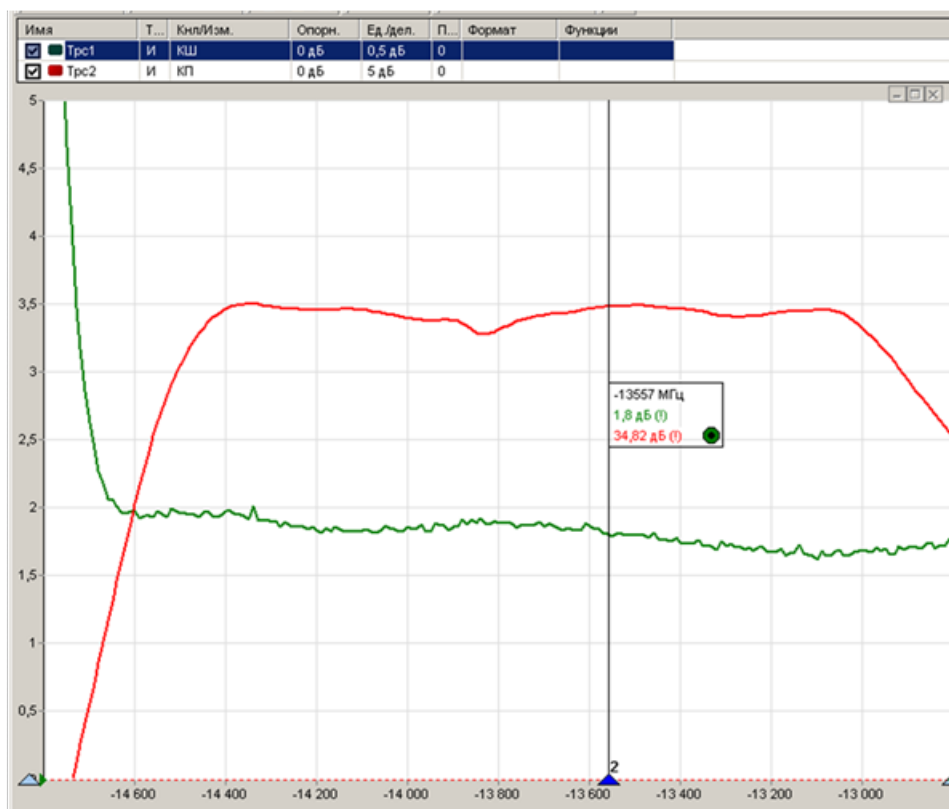
Рисунок 7.13 – Результат измерения КШ и КП преобразователя частоты MD-138015-P1
