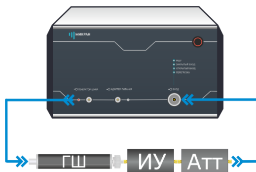
Рисунок 7.1 – Схема измерений ИУ без преобразования по частоте или с внутренним генератором и ФНЧ
