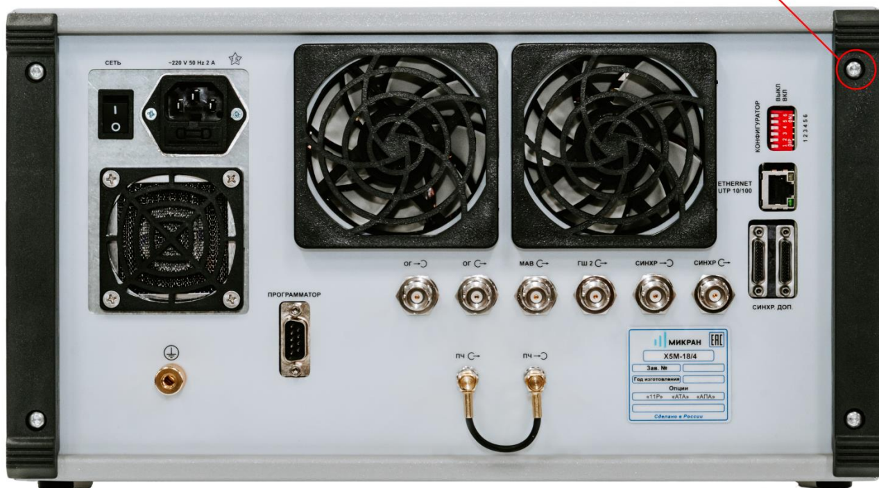
Рисунок 4.4 – Общий вид задней панели X5M-18 со схемой пломбировки от несанкционированного доступа
