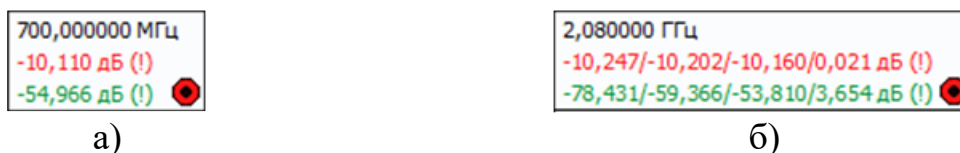
Рисунок 4.40 – Окна индикации маркеров: а) с выключенной статистикой; б) с включённой статистикой
