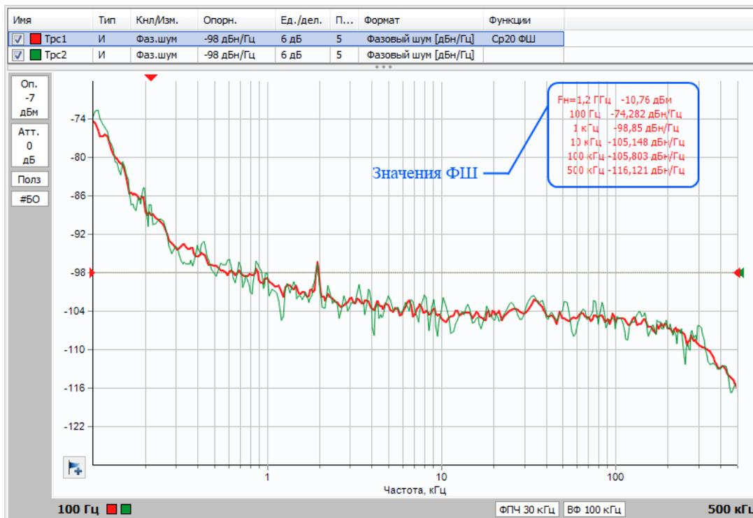
Рисунок 3.10 – Результат измерения фазового шума
