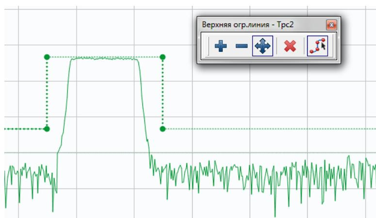
Рисунок 2.33 – Режим графического редактирования ограничительной линии
