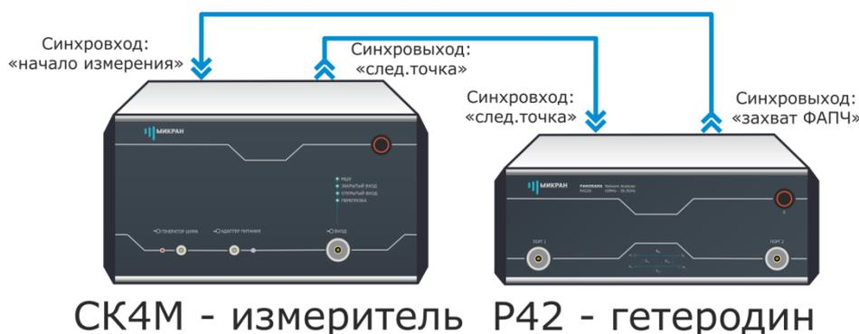
Рисунок 3.19 – Схема подключения входов и выходов синхронизации
