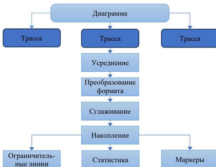
Рисунок 2.22 – Блок-схема обработки данных в трассе
