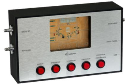
С помощью лабораторного макета для СВЧ-измерений компании «Микран» можно обучать студентов проводить измерения активных и пассивных элементов СВЧ-тракта и демонстрировать возможности измерительных приборов СВЧ-диапазона.
