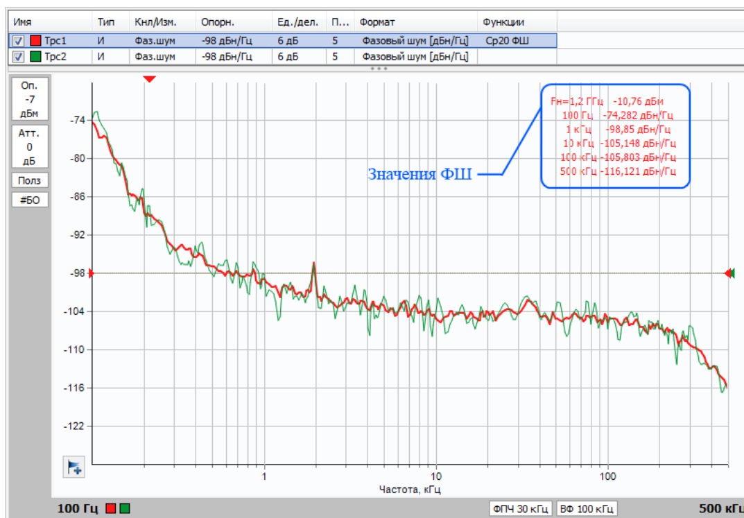
Рисунок 7.5 – Результат измерения фазового шума
