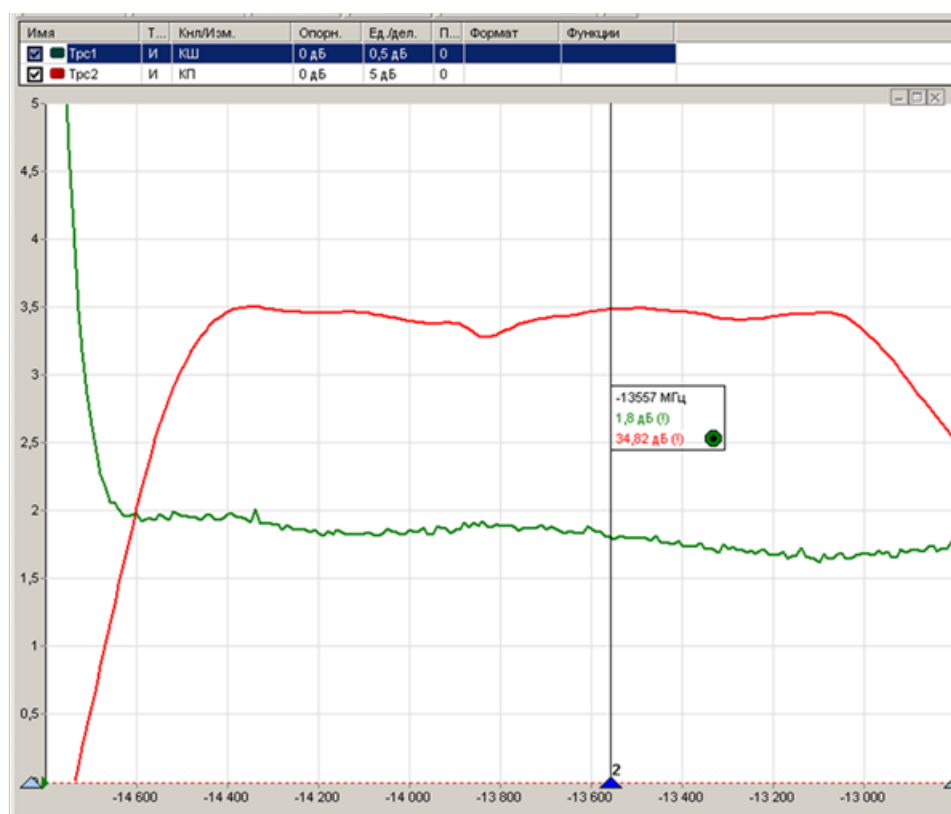
Рисунок 7.18 – Результат измерения КШ и КП преобразователя частоты MD-138015-P1
