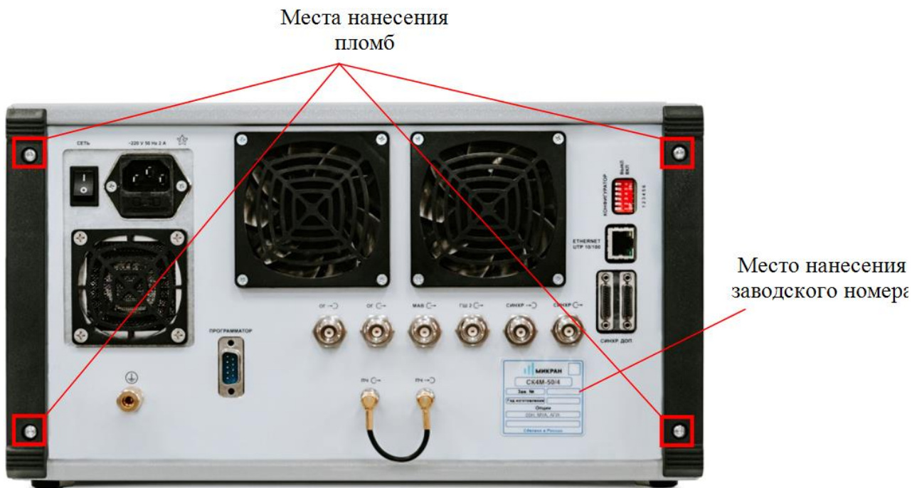
Рисунок 4.3 – Общий вид задней панели СК4 со схемой пломбировки от несанкционированного доступа (для СК4М допускается нанесение пломбы только в правом верхнем углу) и заводского номера
