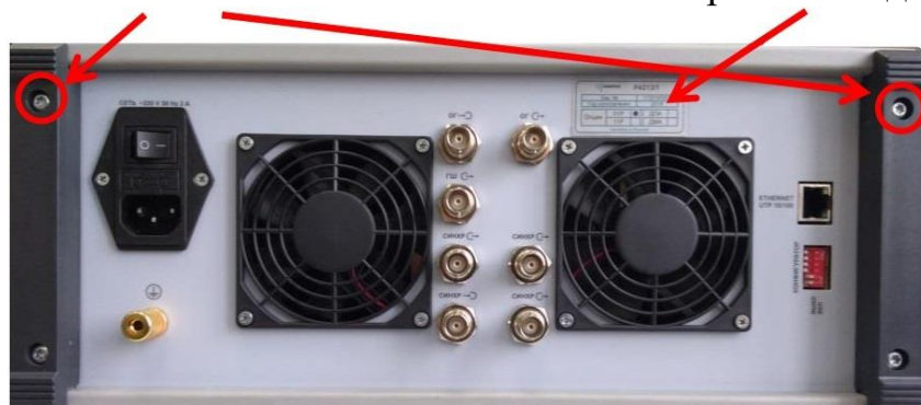
Рисунок 4.3 – Общий вид задней панели Р42 (для одного из вариантов исполнения) со схемой пломбировки от несанкционированного доступа
