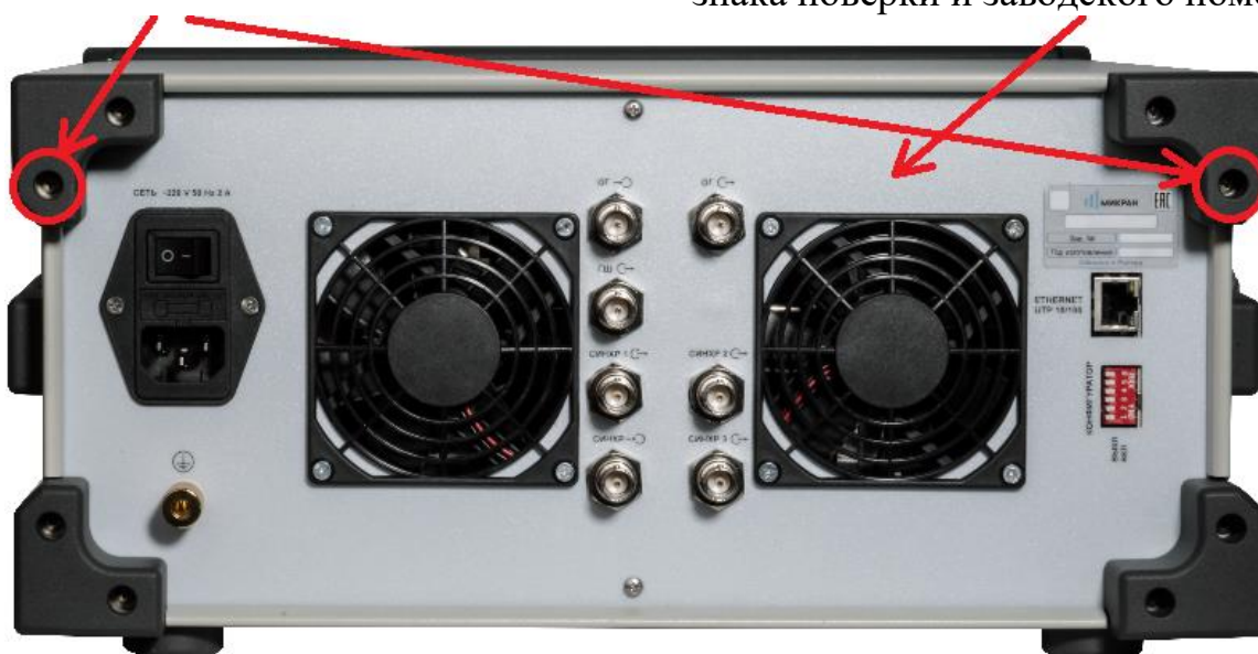
Рисунок 4.4 – Общий вид задней панели Р42 (для одного из вариантов исполнения) со схемой пломбировки от несанкционированного доступа
