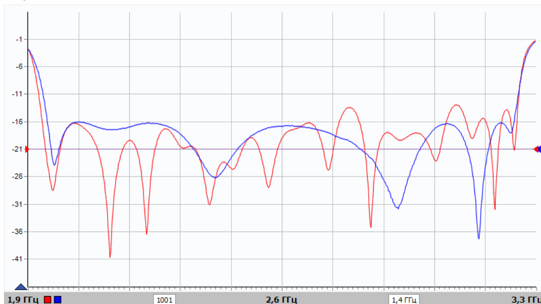
Рисунок 3.21 – Результат компенсации отражения от полосового фильтра
