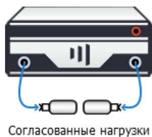
Рисунок 3.20 – Измерение изоляции между портами
