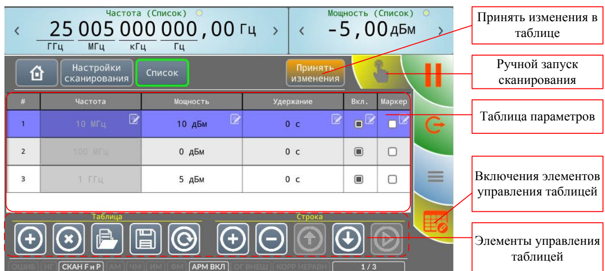
Рисунок 4.2 – Основное окно интерфейса пользователя в меню списка значений частоты и мощности «Список»
